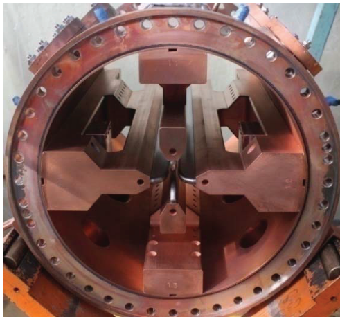
Структура типа "4-vanes" со смещенными окнами (NICA)
