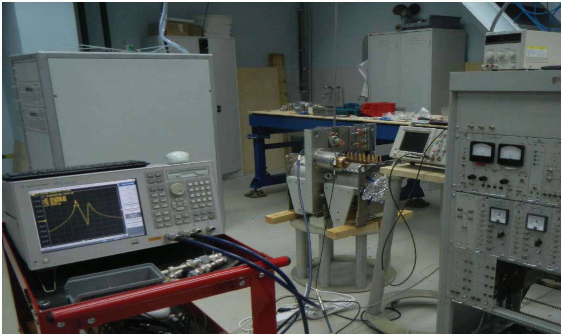
Рис. 2. Испытания резонатора на стенде. Весна 2017 г.
