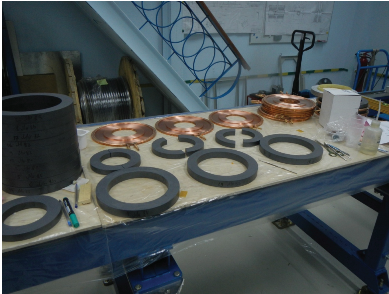
Рабочее место для склейки ферритовых модулей. Клей - кремнийорганический компаунд «ПентЭласт-712» марки А
