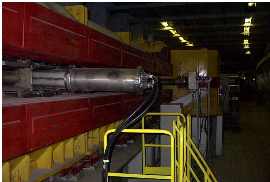
. Станция кристаллических дефлекторов, смонтированная на ускорителе У-70.
