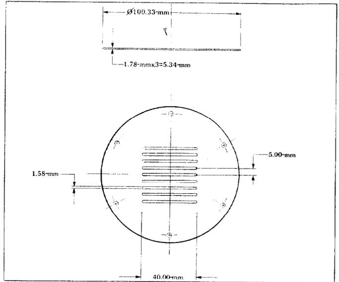
Fig. 2. Tungsten emittance mask.
