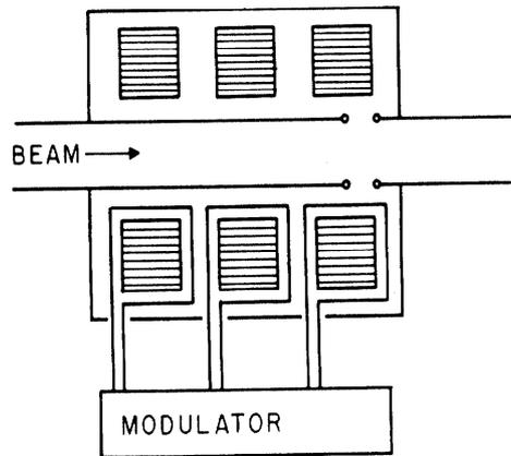
LONGITUDINAL STACKING OF ACCELERATOR CORES TO ACHIEVE VOLTAGE STEP-UP
