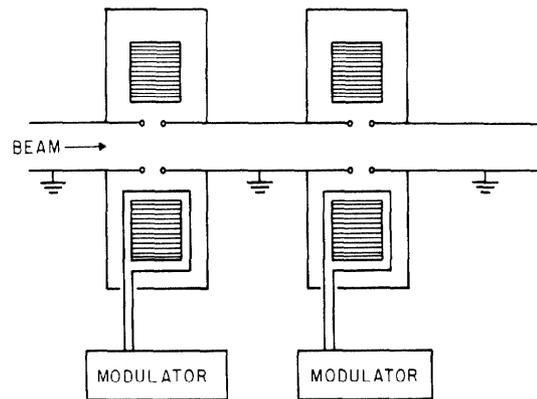
SCHEMATIC OF INDUCTION LINEAR ACCELERATOR
