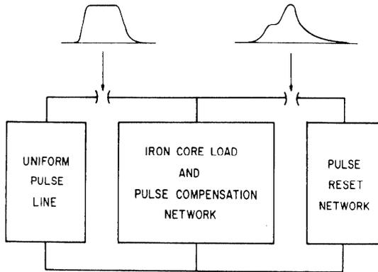
INDUCTION LINAC PULSING SCHEMATIC
