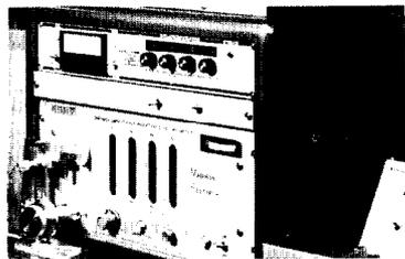
Fig. 5 TLD Readout Instrument
