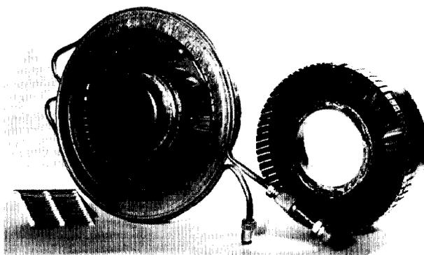
Fig. 10. Two copper fan louver baffles for 6-in. nom. oil diffusion pump.
