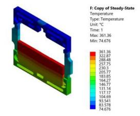
Max. blade temp. 360 °C Max. frame temp. 220 °C
