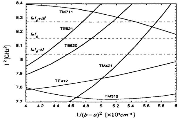
Fig.4 Mode chart ( $f_0=2856\text{MHz}$ ,  $\Delta f=20\text{ MHz}$ ).
