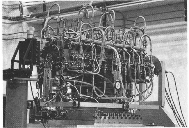
Fig. 1 Assembled DTL Module.
