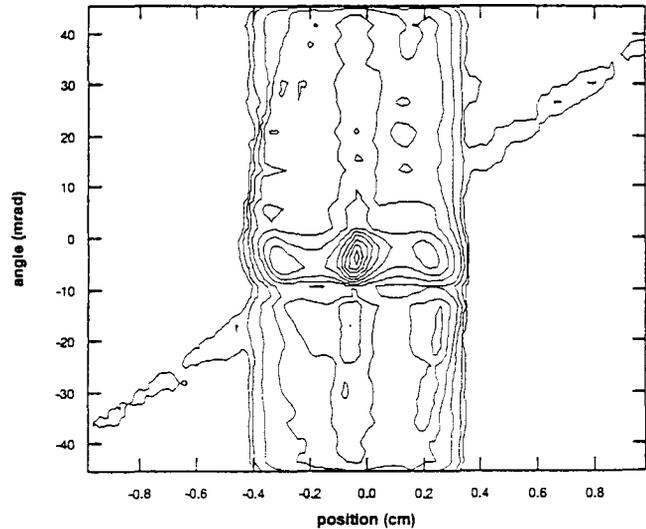
Figure 3 Phase-Space horizontal emittance plot (Einzel)
