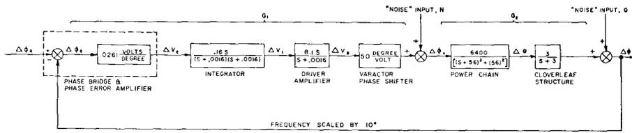
— SYSTEM BLOCK DIAGRAM-INTEGRAL COMPENSATION IN FORWARD LOOP—
