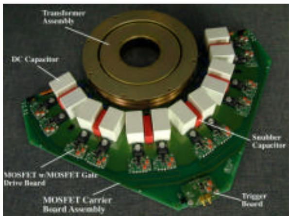
Fig. 4 Transformer Assy. with a MOSFET Carrier Bd.
