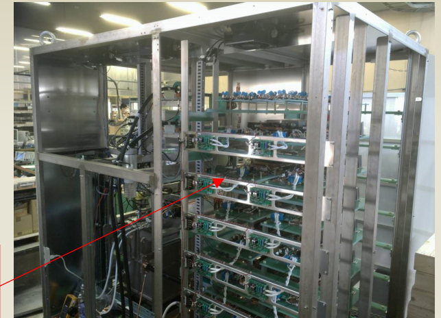
HV-IGBT (Mitsubishi CM750HG-130R) 6.5 kV, 750 A dc, T_r \sim 200 ns
