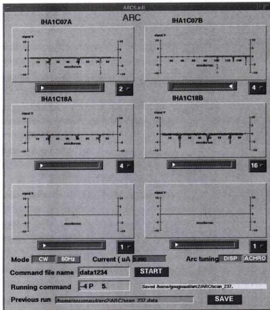
Figure 2 : Beam profiles
