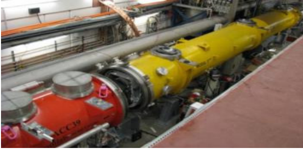
3 rd harmonic sc module 3.9 GHz
