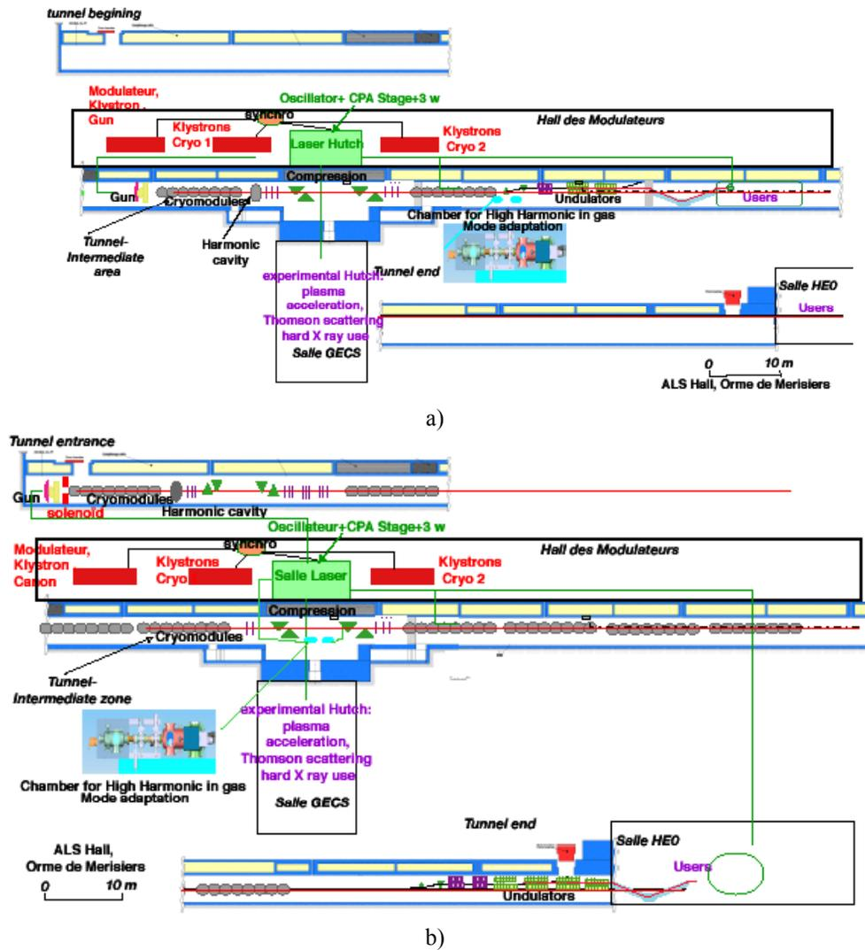
Figure 2: a) Scheme of ARC-EN-CIEL phase 1 in the tunnel of ALS at CEA (Commissariat à l'Énergie Atomique) in Orme des Merisiers. b) Scheme of ARC-EN-CIEL phase 2 in the tunnel of ALS.
