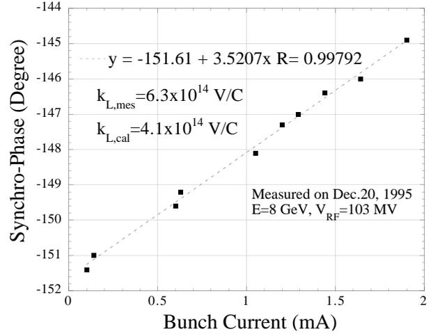
Fig. 3 Global Longitudinal Loss Factor
