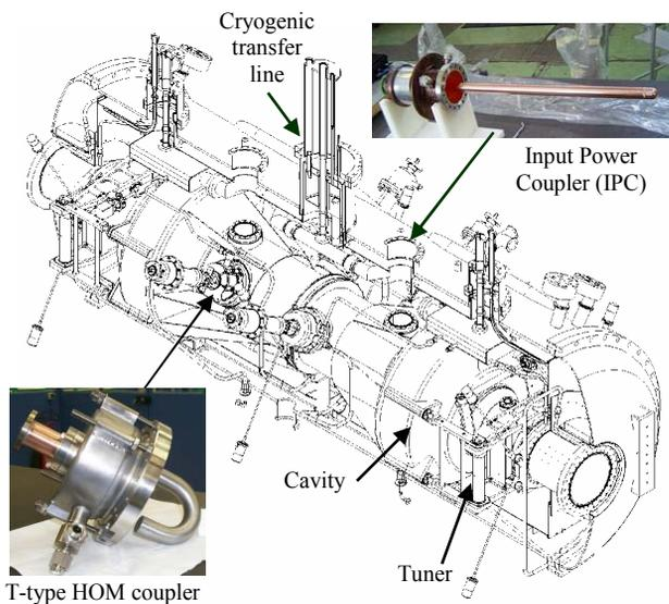
Figure 4: The SOLEIL cryomodule (CM).
