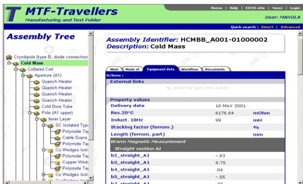
Figure 2 - LHC cryodipole parameters
