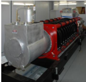
1MW CW Klystron
