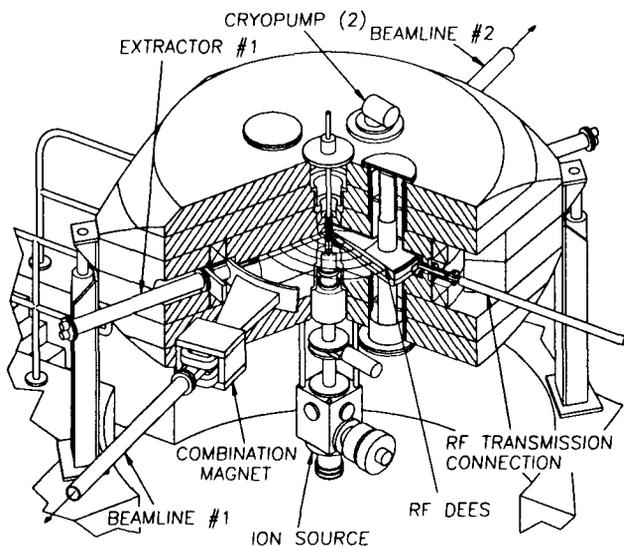
Fig. 1. TR30 cyclotron.
