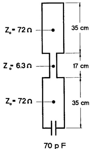
Fig. 7. Impedance diagram.
