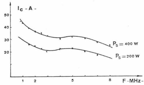
Fig. 7 : Collector current versus fréquence .
