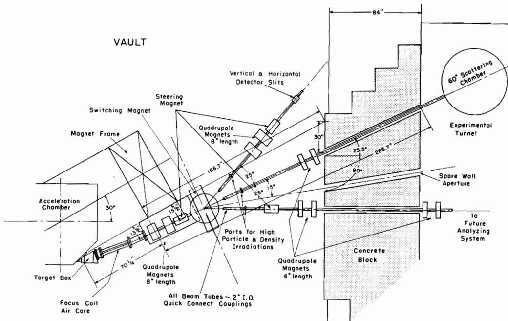
Fig. 265. Focusing system, Argonne cyclotron.
