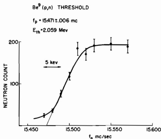
Fig. 214. Measurement of the Be<sup>9</sup>(p,n)B<sup>9</sup> threshold.
