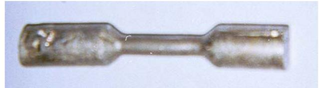
Figure 1: Li tensile specimen.
