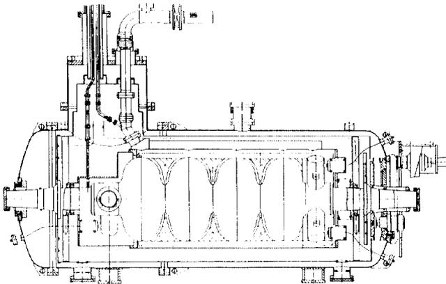
Fig. 5 - 500 MHz Accelerator Module.
