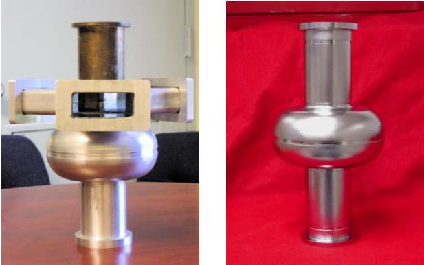
Fig. 6a) 1.5 GHz warm model, 6b). 1-cell niobium model.
